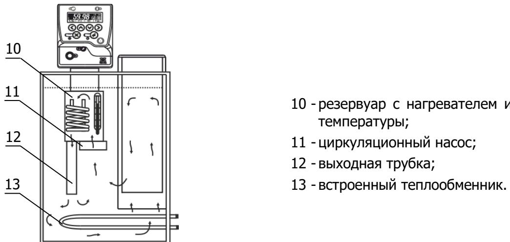
Рисунок 3 — Принцип работы термостата
