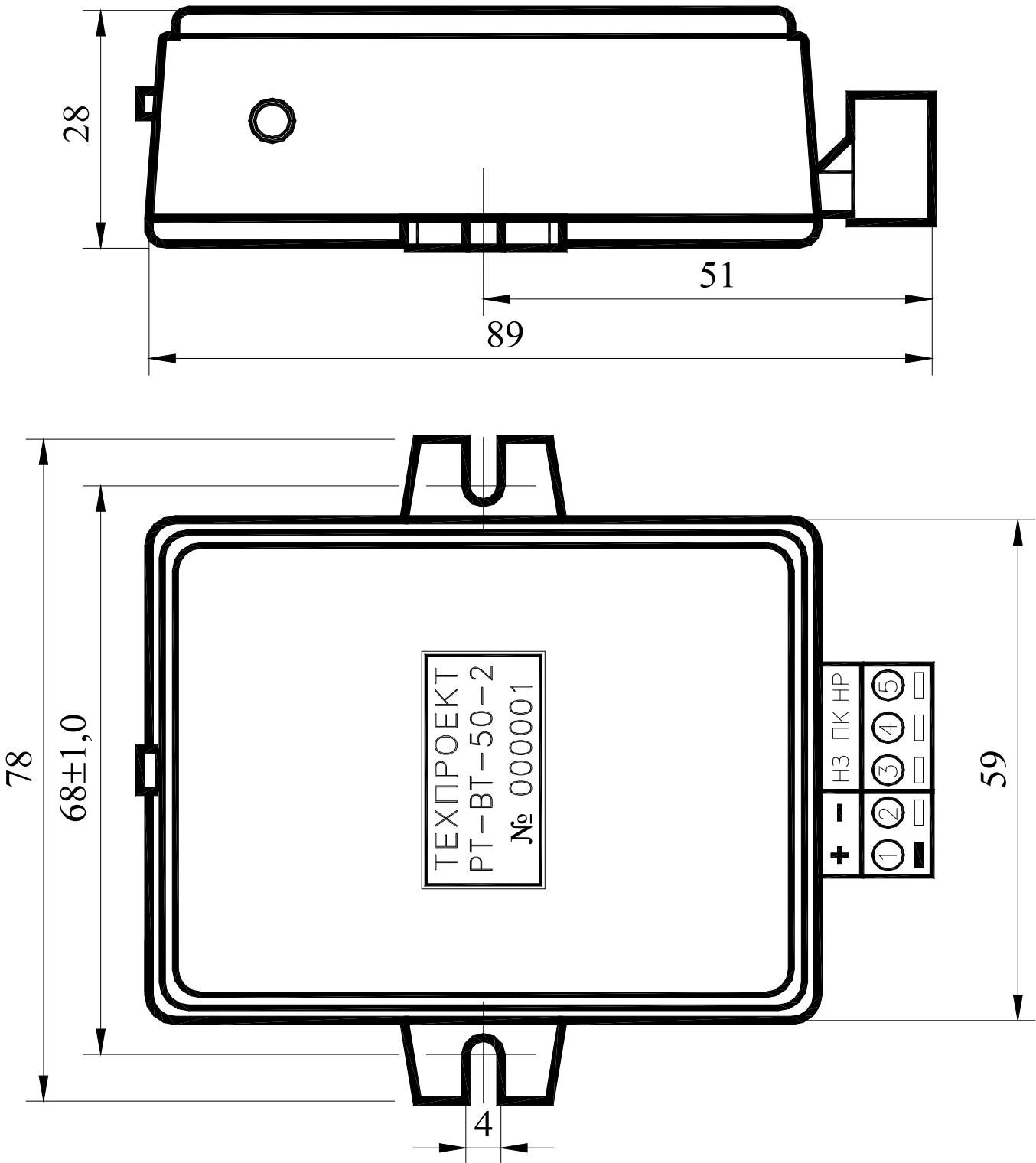
Рисунок 1 - Габаритные размеры РТ-ВТ ААРЛ.433647.004-04
