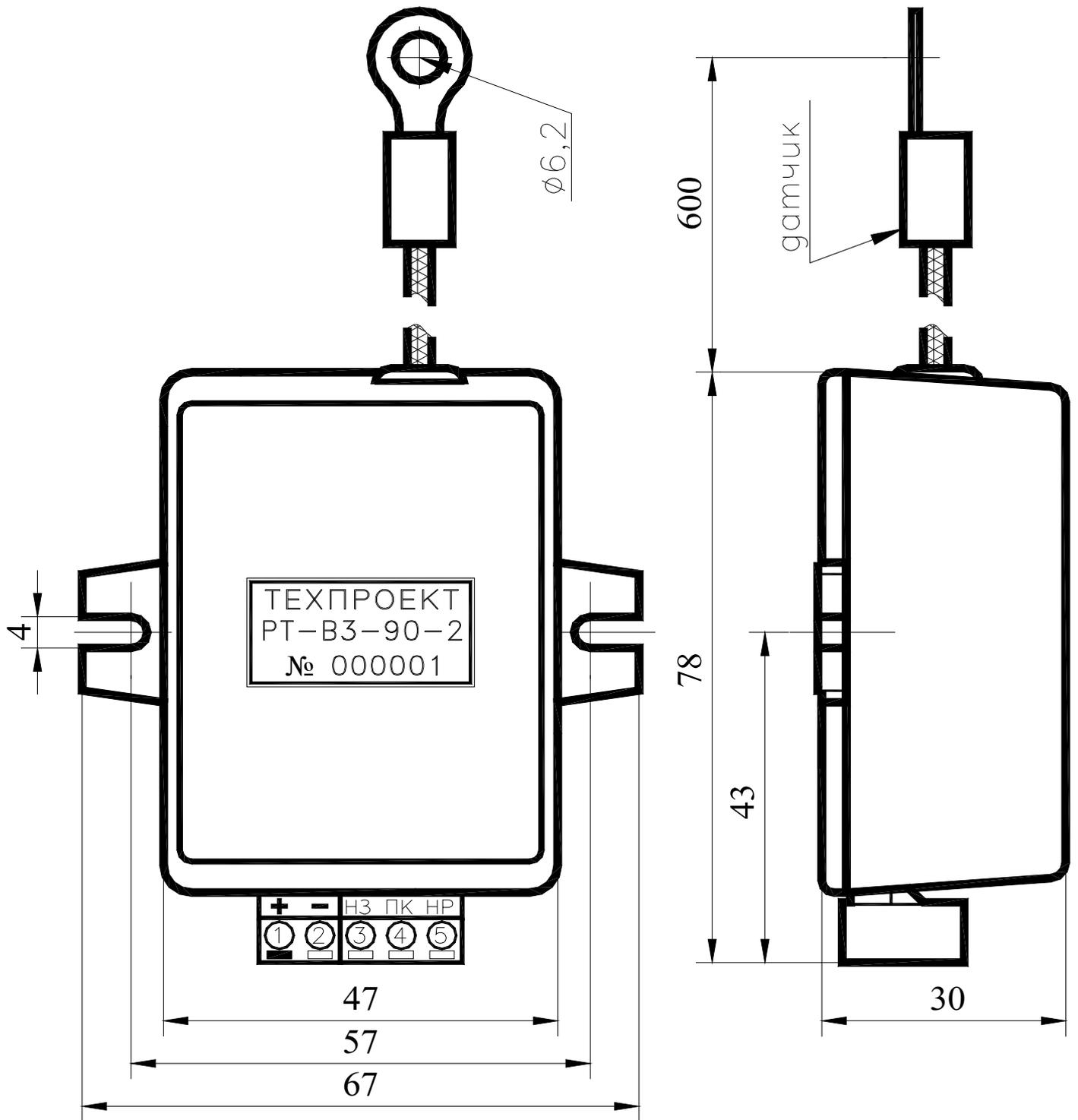
Рисунок 1 - Габаритные размеры РТ-ВЗ ААРЛ.433647.004-05
