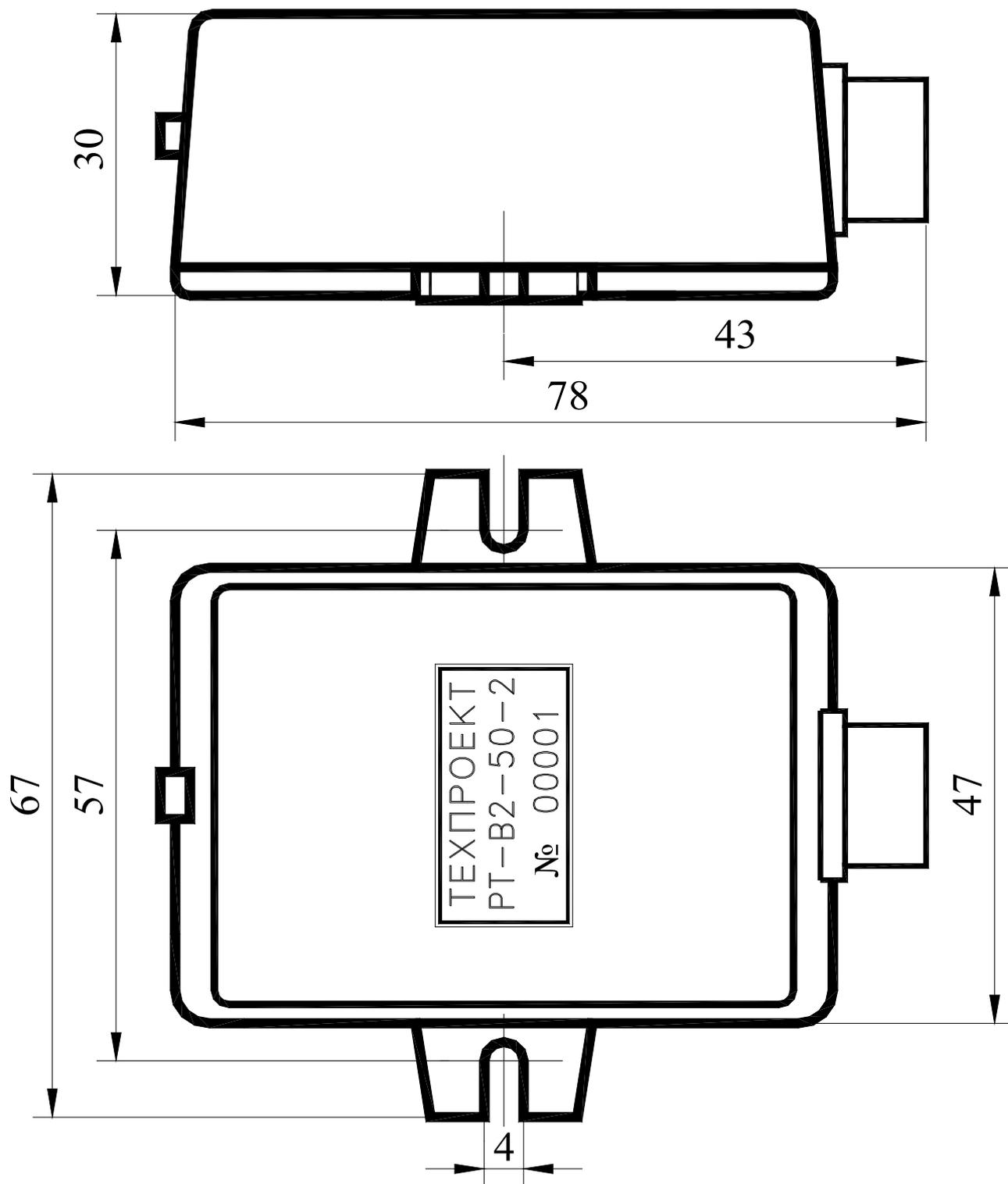
Рисунок 1 - Габаритные размеры РТ-В2 ААРЛ.433647.004-03
