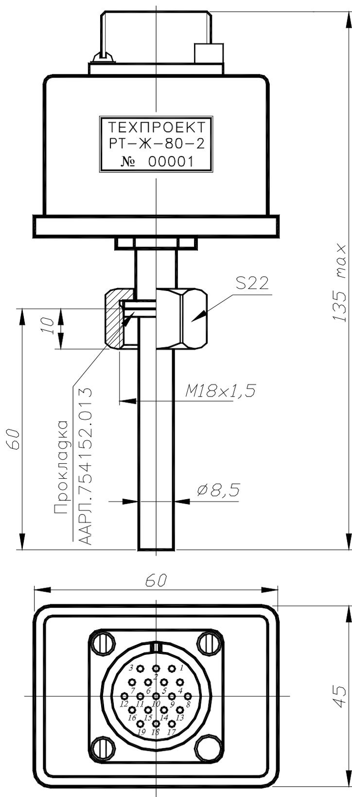
Рисунок 1 - Габаритные размеры РТ-Ж ААРЛ.433647.004
