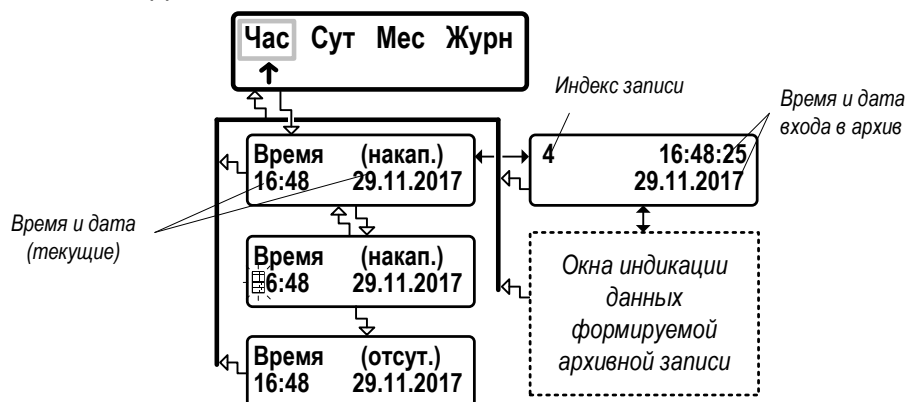
а) окна индикации буферного накопителя
