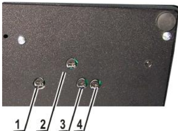
Рис.4. Регулировочные элементы основания ПГС-5-12М
