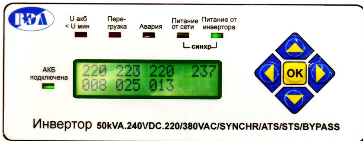
Рис. 2 Расположение органов управления и индикации инвертора
