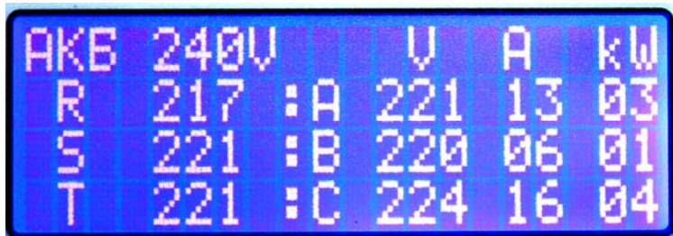
Рис. 6. Экран дисплея инвертора Основной экран в режиме «Работа»
