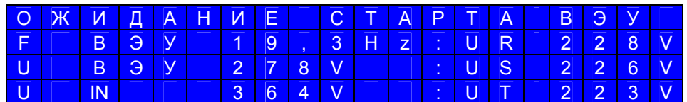
Рис.6. Экран инвертора в режиме ожидания старта ВЭУ
