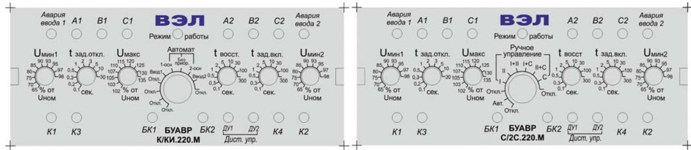
Рис. 3 Расположение органов управления и индикации БУАВР.К и БУАВР.КИ
