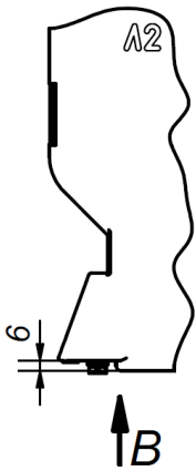
Рисунок 8 – Габаритный чертеж трансформатора тока ТОЛУ-10-2.ХН. Остальное см. на рис. 1.
