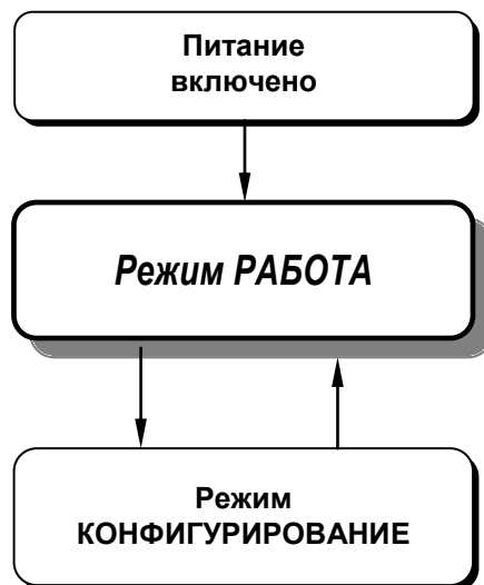
Рисунок 4.6.1 – Диаграмма режимов работы и настройки преобразователя ПНС-13
