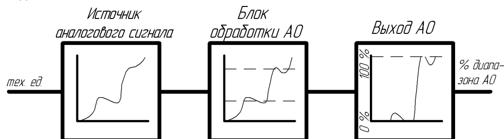
Рисунок 3.6 – Работа блока аналогового вывода в режиме ретрансмиссии
