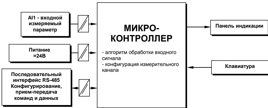
Рисунок 5.3 - Структурная схема индикаторов ИТМ-1-10 и ИТМ-1-14
