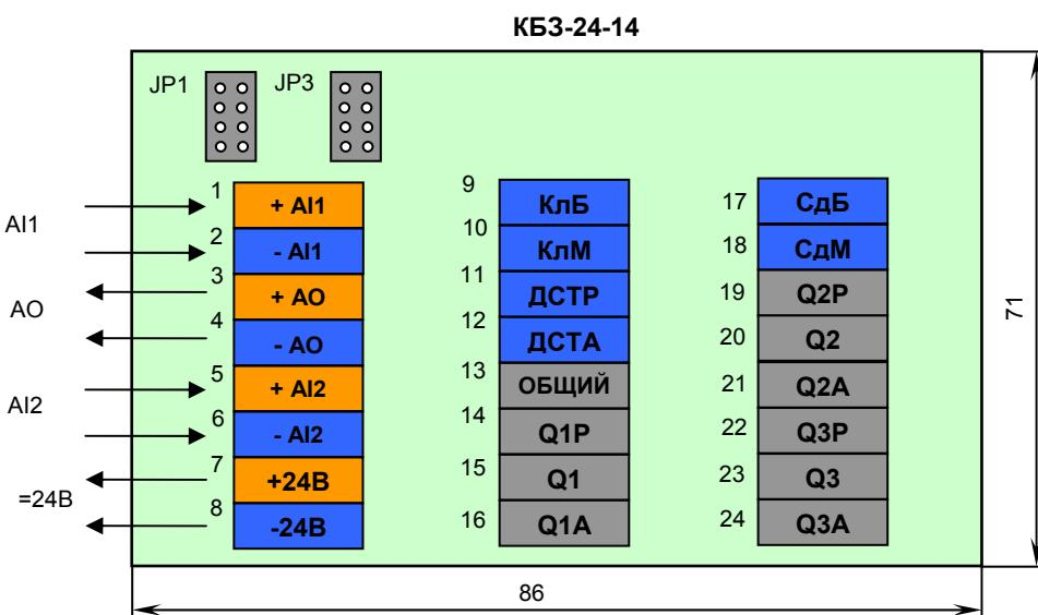
Рисунок Б.2 - Схема расположения сигналов и габаритные размеры клеммно-блочного соединителя КБЗ-24-14
