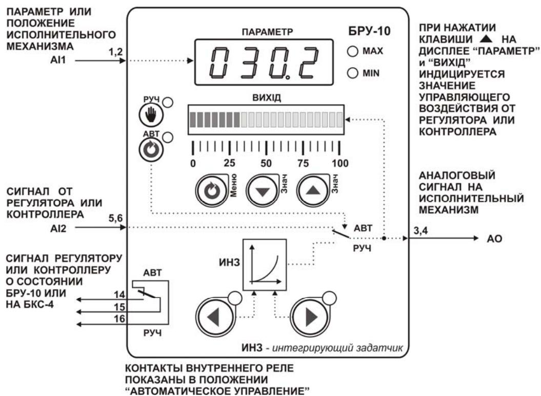
Рисунок 7.3.1 - Блок-схема режима 2
