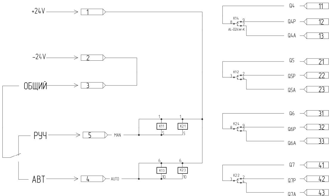
Рисунок. 5.2 – Электрическая схема блока коммутации сигналов БКС-4.
