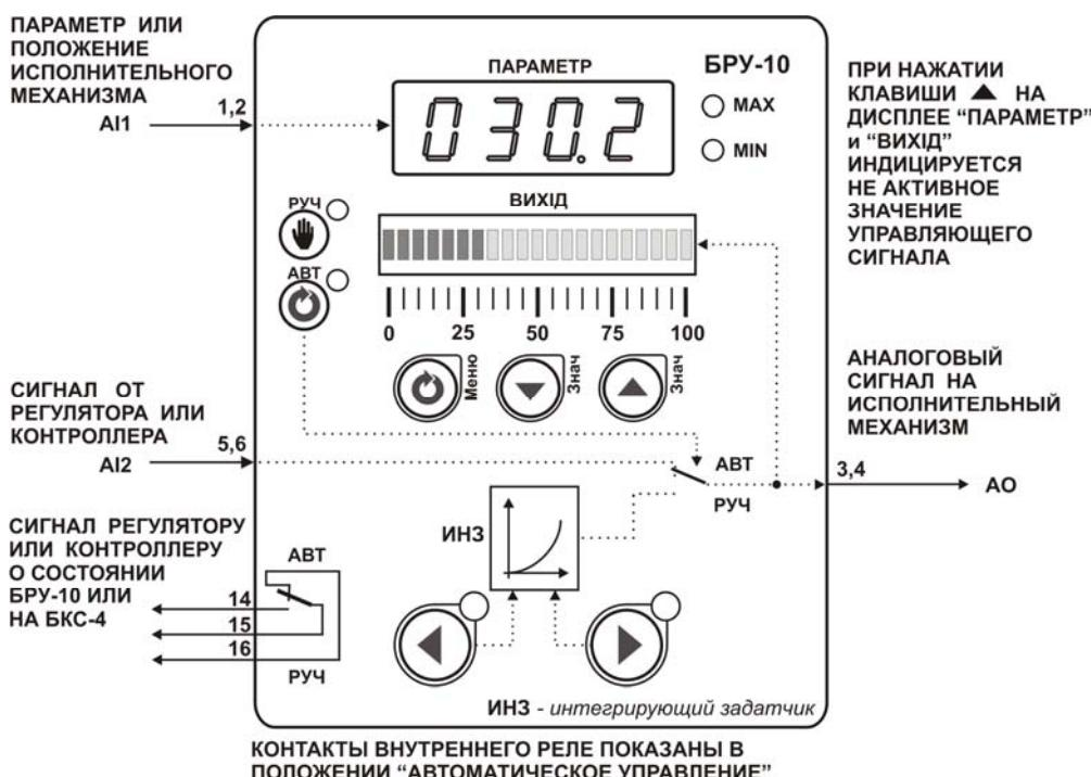
Рисунок 7.12.1 - Блок-схема режима 11
