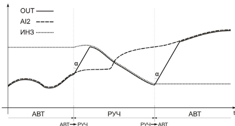
Рисунок 7.2 – График работы балансировок режима 2
