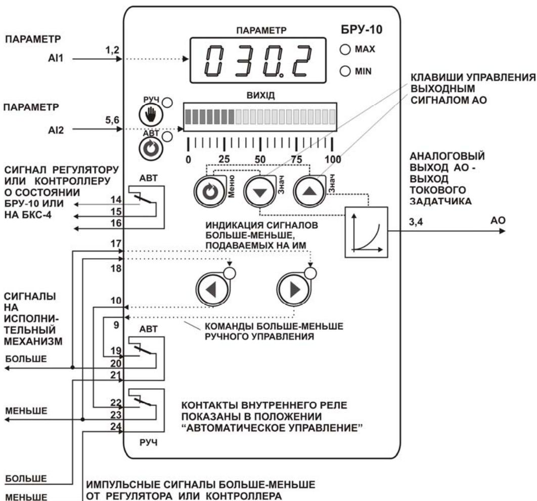
Рисунок 7.9.1 - Блок-схема режима 8
