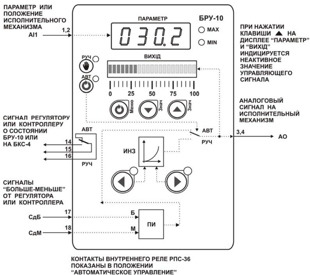
Рисунок 7.5.1 - Блок-схема режима 4
