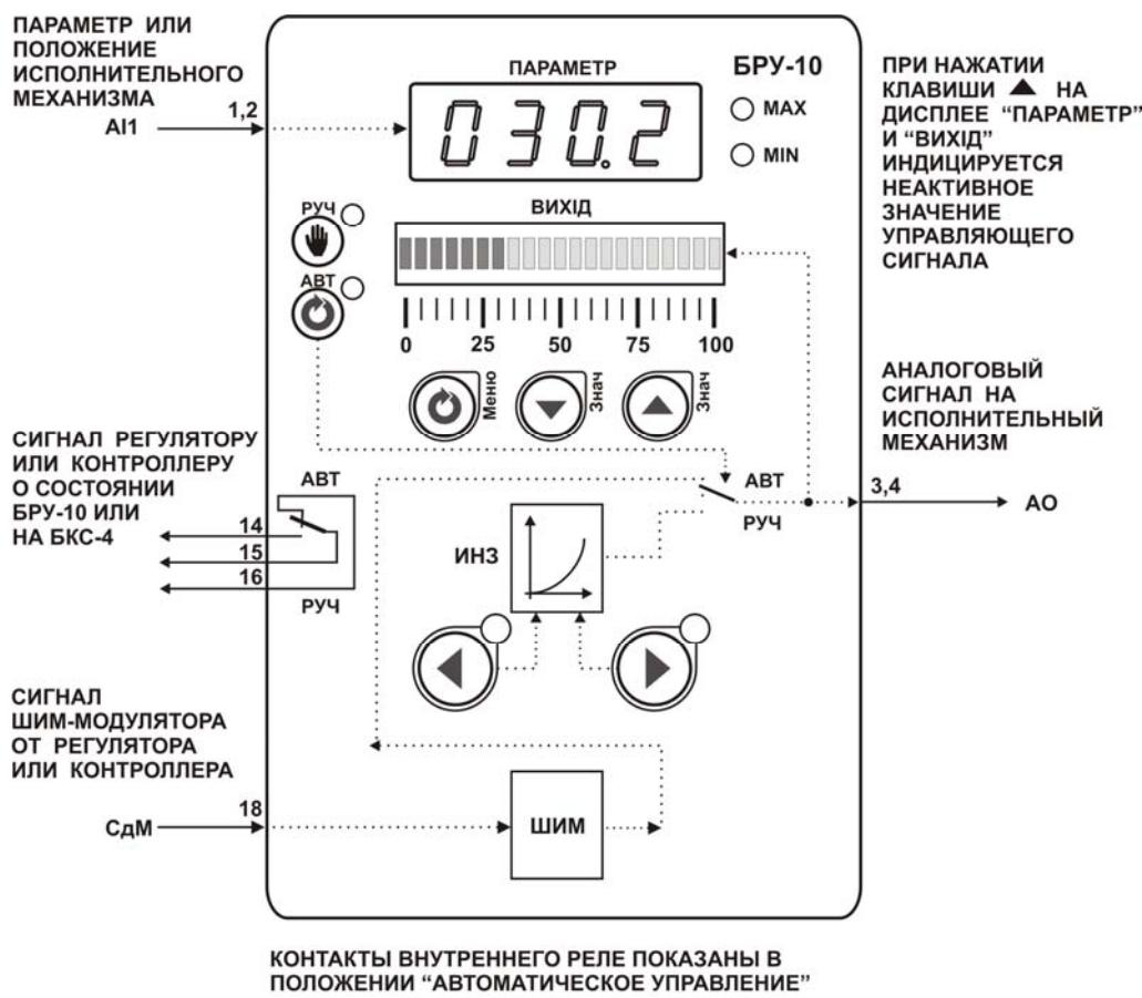
Рисунок 7.6.1 - Блок-схема режима 5
