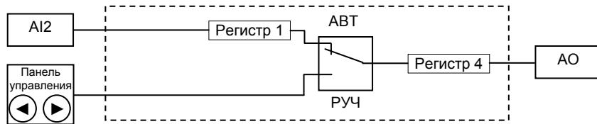
Рисунок 7.2.2 - Функциональная схема балансировок режима 1
