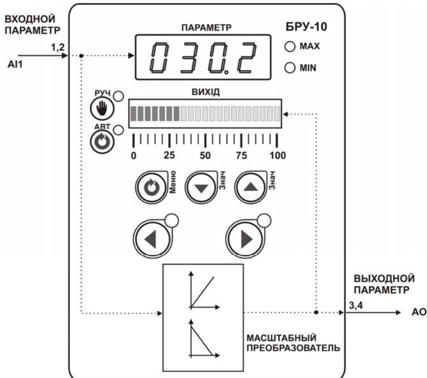
Рисунок 7.7.1 - Блок-схема режима 6
