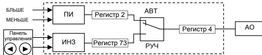
Рисунок 7.5.2 - Функциональная схема балансировок режима 4
