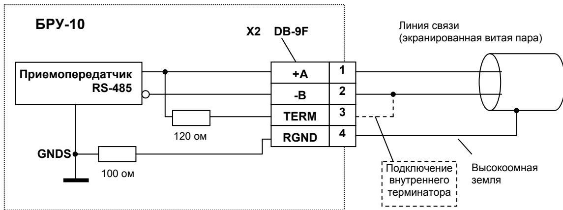
Рисунок Б.11 - Подключение терминального резистора в блоке ручного управления БРУ-10
