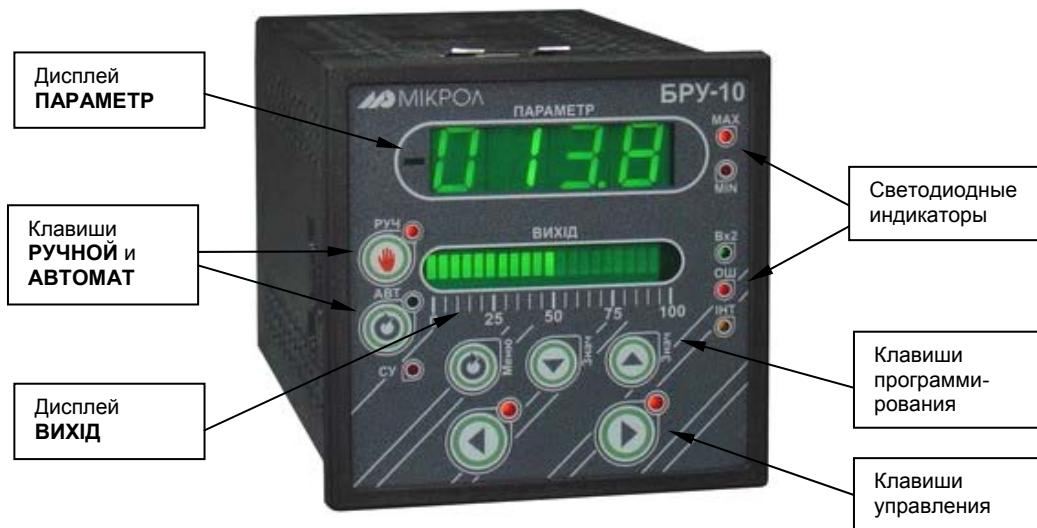
Рисунок. 5.1 - Внешний вид передней панели блока ручного управления БРУ-10
