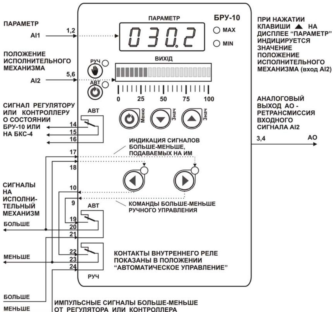
Рисунок 7.4.1 - Блок-схема режима 3
