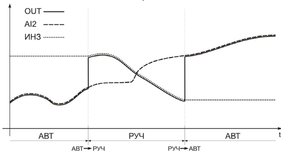
Рисунок 7.1 – График работы балансировок режима 1
