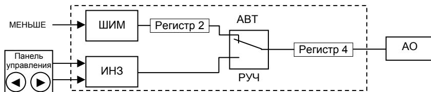
Рисунок 7.6.2 - Функциональная схема балансировок режима 5
