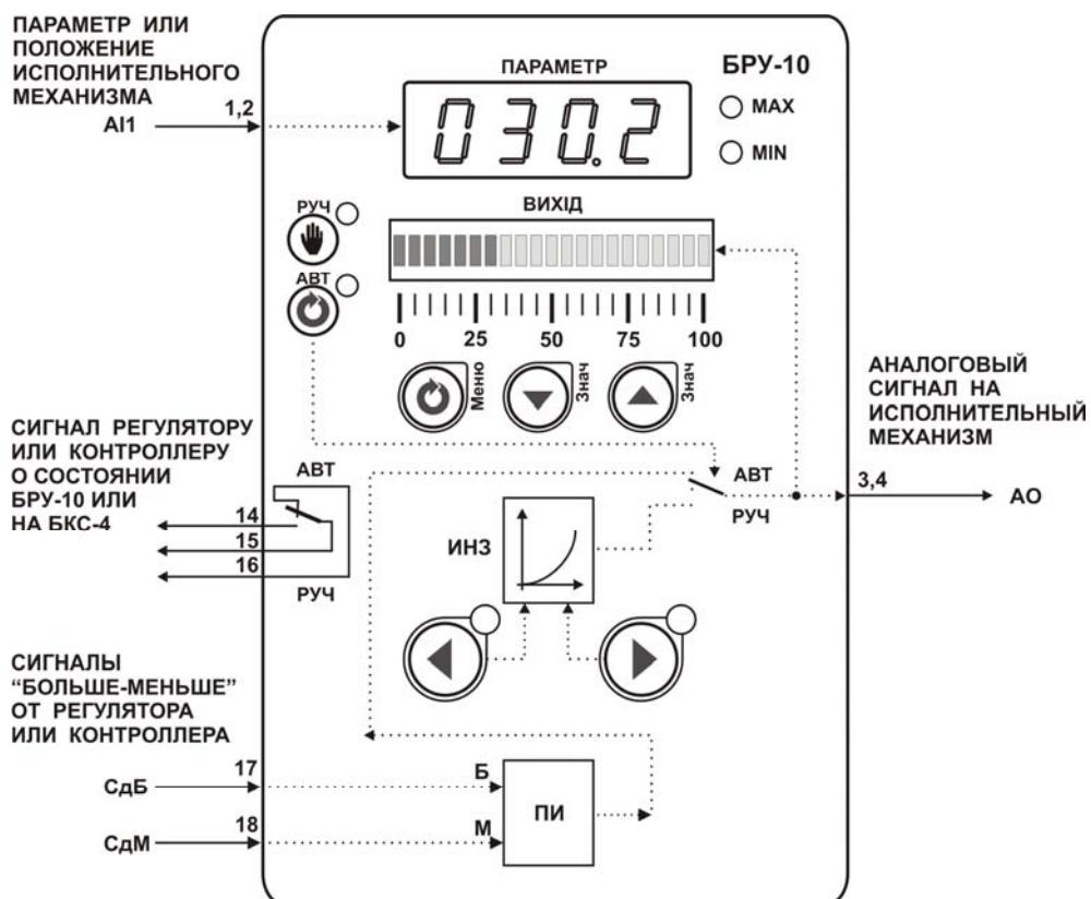
Рисунок 7.10.1 - Блок-схема режима 9
