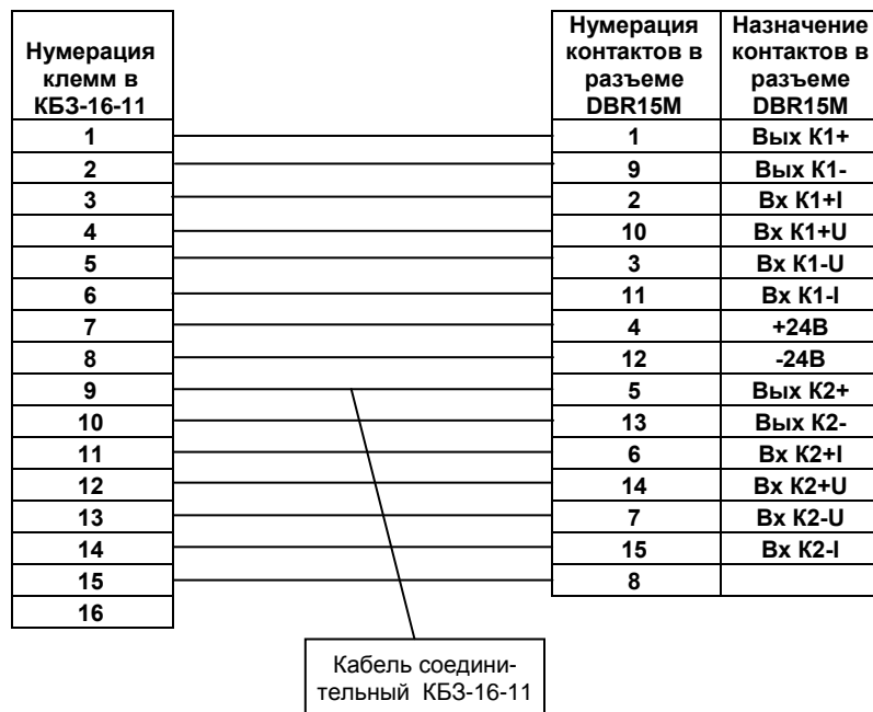
Рисунок 2.3 - Схема распайки кабеля клеммно-блочного соединителя KB3-16-11 и внешние сигналы БПО-42
