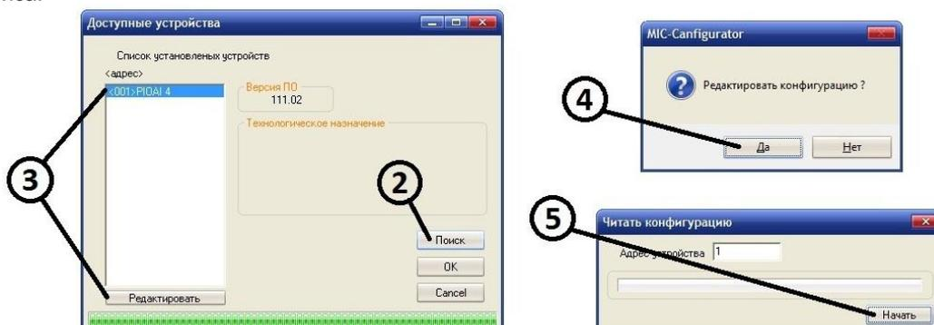
Рисунок 4.3 – Поиск доступных устройств и считывание параметров модуля
