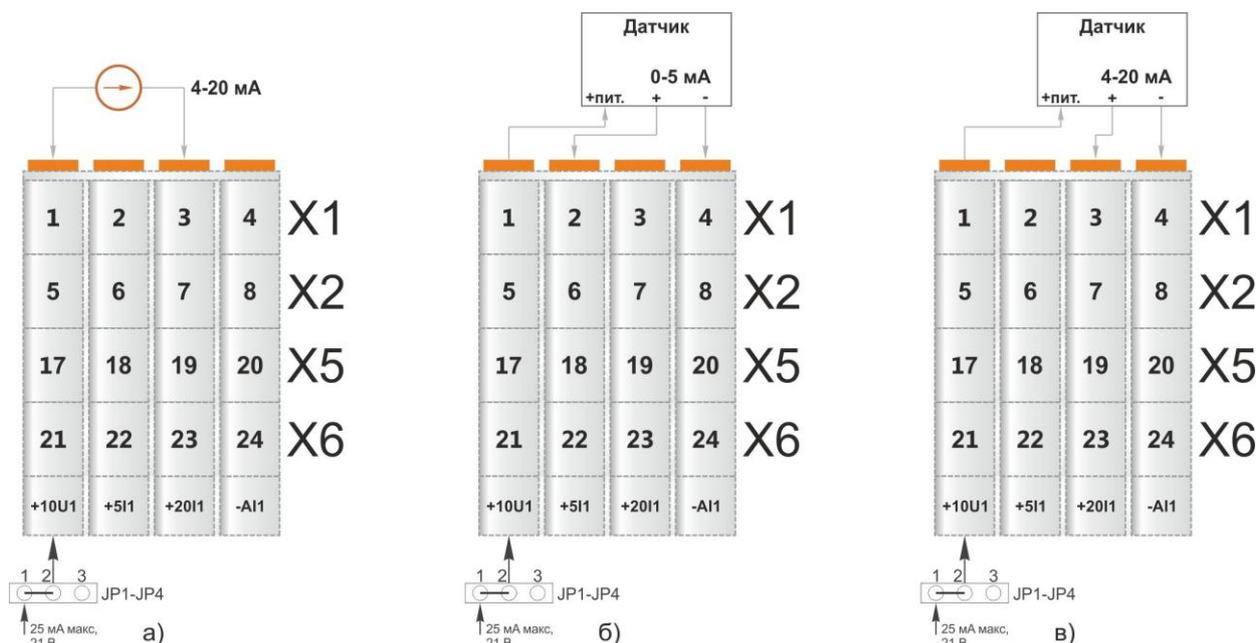
Рисунок Б.4 - Схема подключения датчиков с пассивным выходом:
