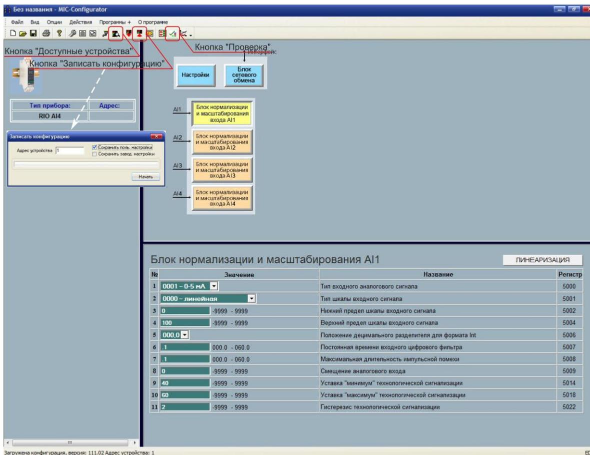
Рисунок 4.4 – Редактирование конфигурации
