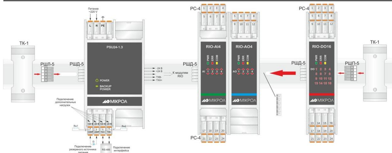
Рисунок Б.3 - Схема внешних соединений RIO-AI4 с блоком питания и другими модулями
