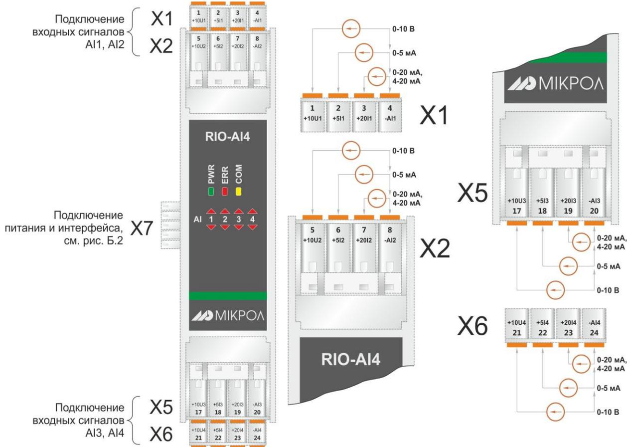
Рисунок Б.1 – Нумерация клемм и сигналы модуля аналогового ввода
