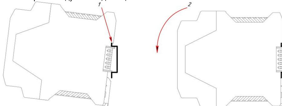
Рисунок 4.1 – Схема крепления модуля на DIN-рельсе
