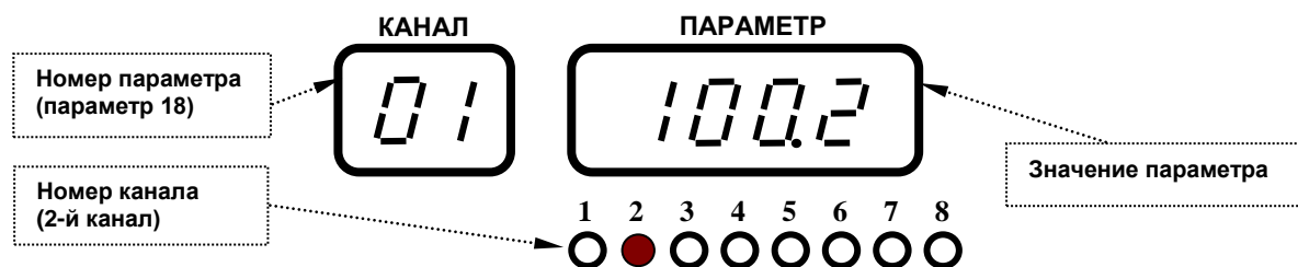
Рисунок 4.4 - Индикация значения номера канала, номера параметра и его значения
