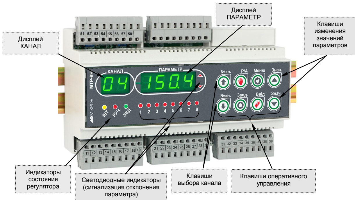
Рисунок 3.1 - Внешний вид передней панели регулятора МТР-8Н
