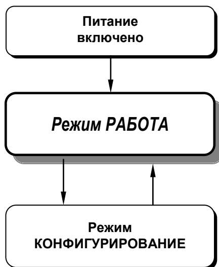
Рисунок 4.1 - Диаграмма уровней работы, защиты и настроек счетчика МТЛ-32Н
