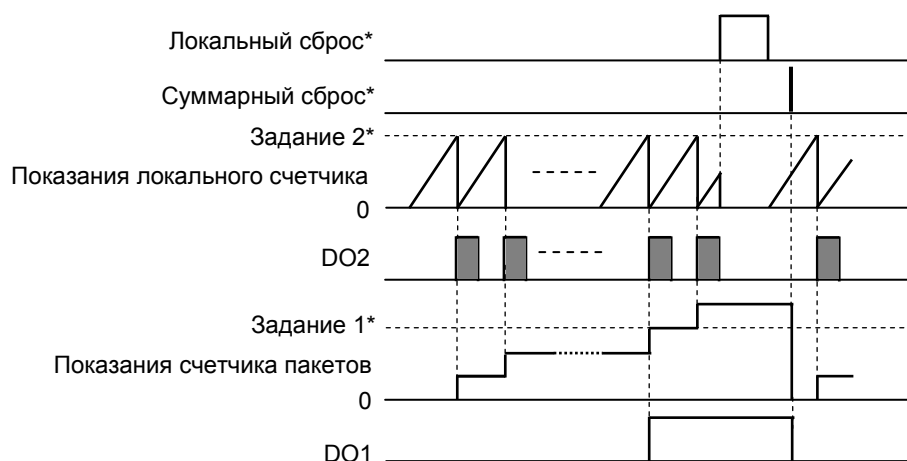
Рисунок 5.4 Диаграмма работы счетчика пакетов.
