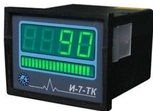
Индикатор технологический И-7-ТК предназначен для измерения унифицированного сигнала постоянного тока, преобразования измеренного значения в пропорциональное значение физической величины, отображения результатов измерения на цифровом индикаторе, а также на индикаторе уровня.
