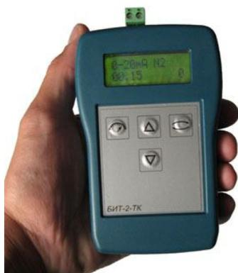
Батарейный источник тока БИТ-2-ТК предназначен для формирования образцовых сигналов постоянного тока/напряжения при калибровке метрологических характеристик измерительных цифровых приборов типа ИП-4-ТК, ИП-5-ТК, ИП-6-ТК, ИП-6М-ТК, ИП-7-ТК или приборов других типов, использующих в качестве входного сигнала величину постоянного тока (напряжения).
