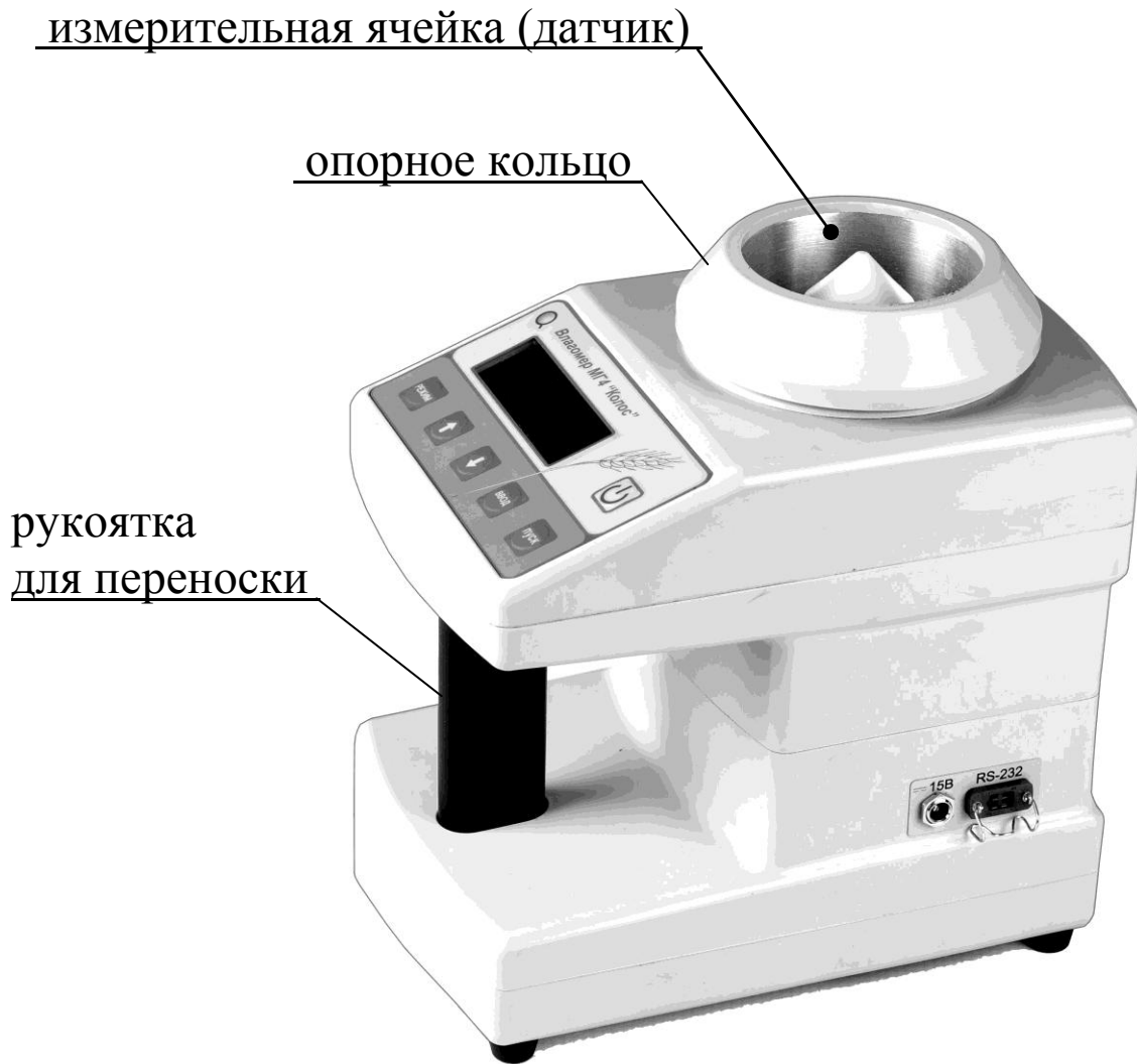
Рисунок 4.1. Общий вид влагомера МГ4 «Колос»
