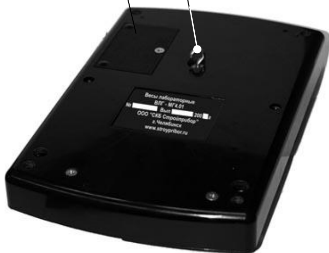
Рисунок 2 - Вид нижней крышки весов ВЛГ-МГ4.01
