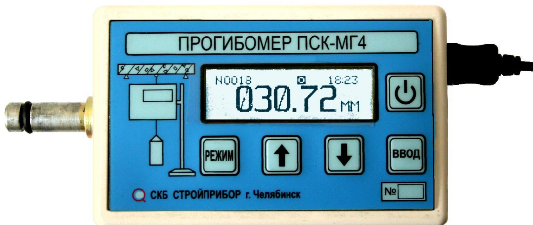
Рисунок 2 – Вид электронного блока прогибомера.
