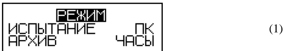
2.3.2 Убедиться, что стакан заполнен водой и, нажатием кнопки **ВВОД** перевести аппарат в режим «Испытание».
