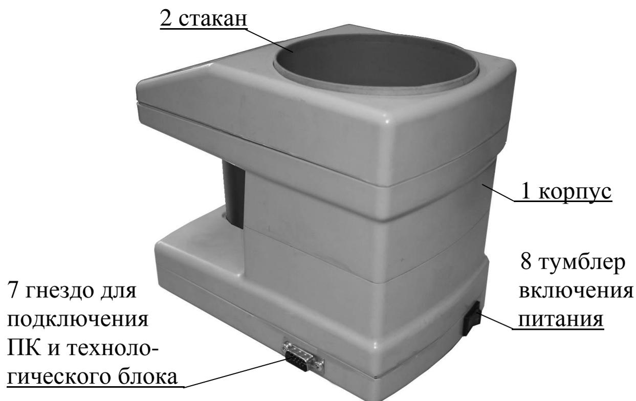
Рисунок 1 - Общий вид электронного блока аппарата ИКШ-МГ4
