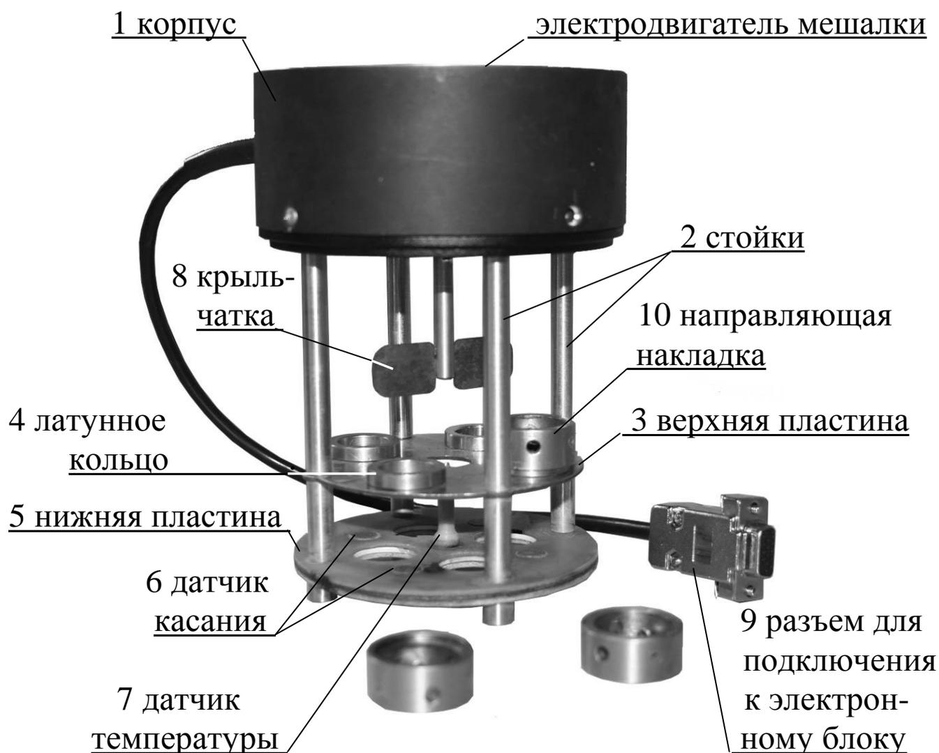
Рисунок 2 - Общий вид технологического блока аппарата ИКШ-МГ4
