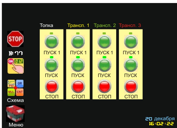
Рис. 102. Меню “Процесс” (Блок “Панель управления”, тип “OFF_ON2”)
