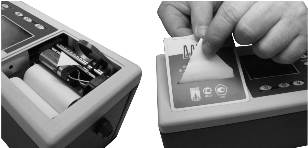
Рис Б.2. Газоанализатор ДАГ-510, замена бумаги в принтере.
