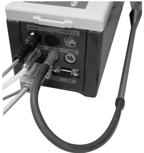
Рис. Б.8 Проверка герметичности (закрытый тракт)
