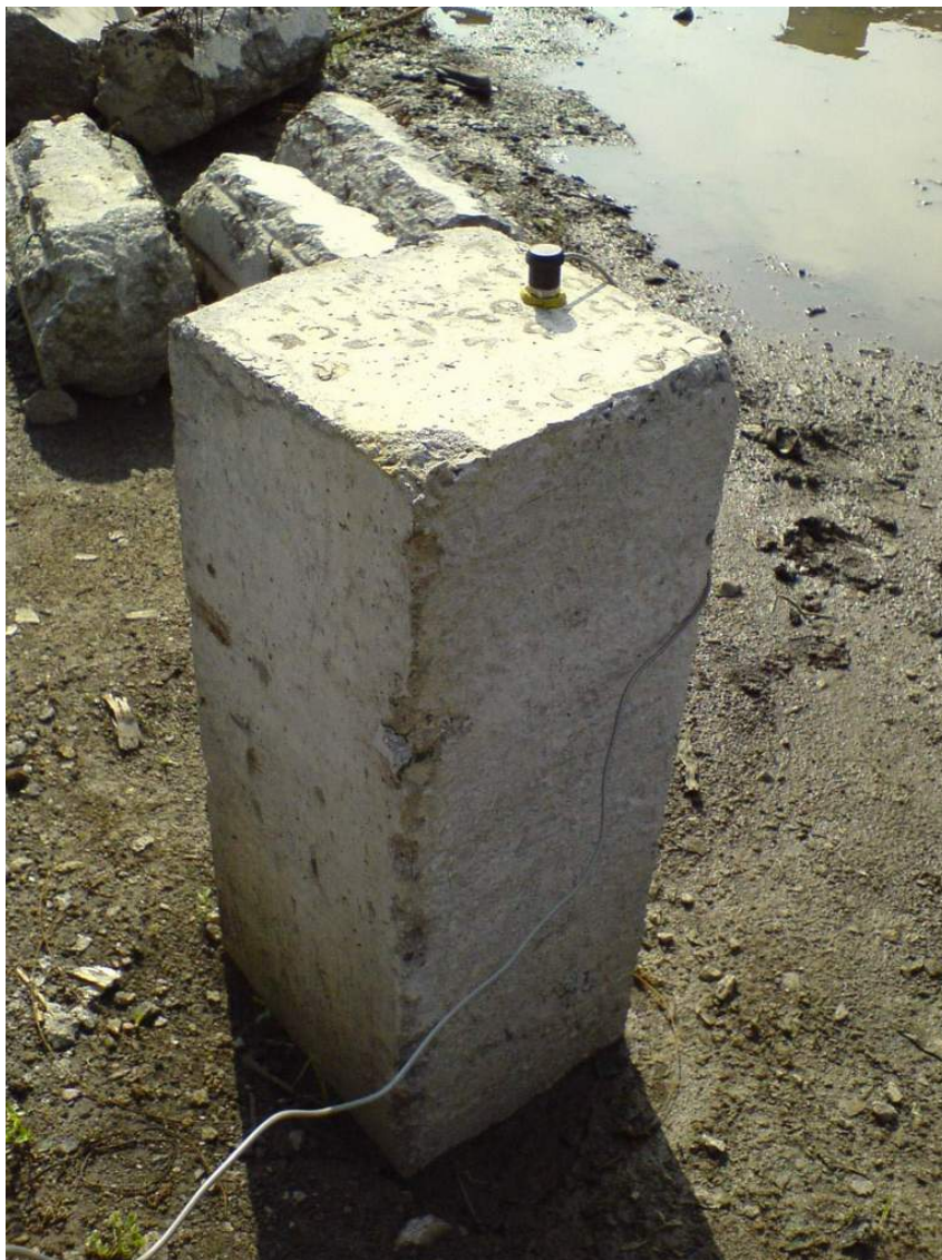
Рис. 2.2. Пример установки датчика на железобетонную сваю.
