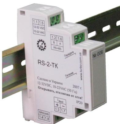
Модуль вывода токового сигнала RS-2-ТК формирует унифицированный токовый сигнал на основе данных, получаемых по интерфейсу RS-485 (протокол MODBUS RTU).
