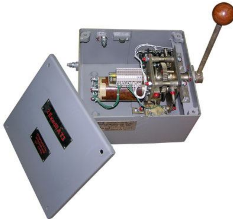
Рисунок 3 — Устройство командоаппарата потенциметрического типа КАПВ
