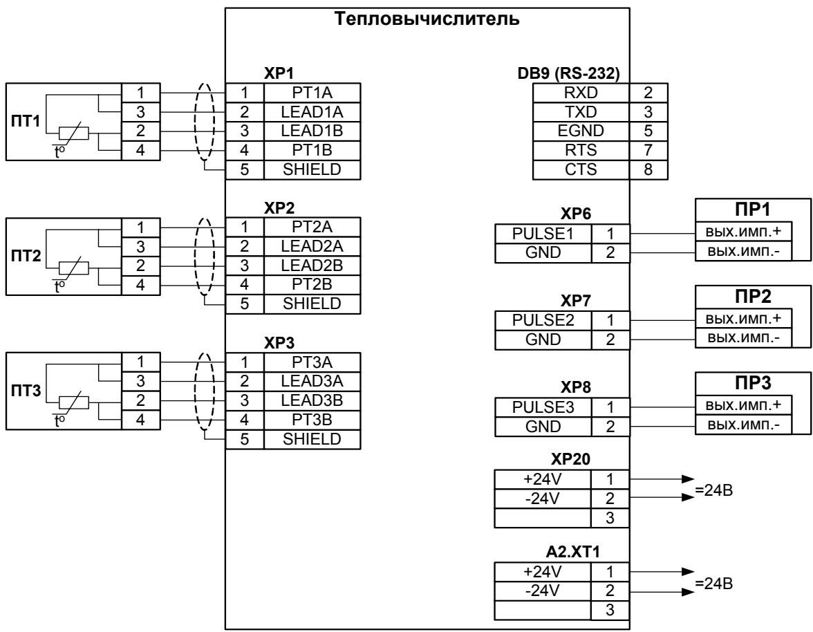
**ПРИМЕЧАНИЕ.** Источник вторичного питания =24В подключается только к теплосчетчику исполнения TCP-034.
