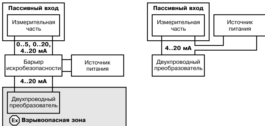
Подключение двухпроводных преобразователей к пассивному входу
